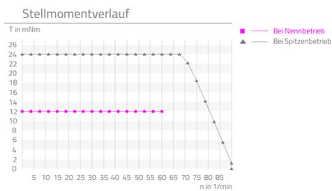
P-029 Kurve gemessen bei 5x Nennspannung mit einem Lastträgheitsmoment  $6 \cdot 10E-9 \text{ kg/m}^2$  im  $\frac{1}{4}$  Mikroschrittbetrieb
