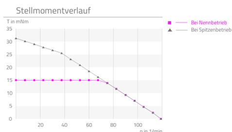
P-029 Kurve gemessen bei 5x Nennspannung mit einem Lastträgheitsmoment  $6 \cdot 10^{-9} \text{ kg/m}^2$  im  $\frac{1}{4}$  Mikroschrittbetrieb
