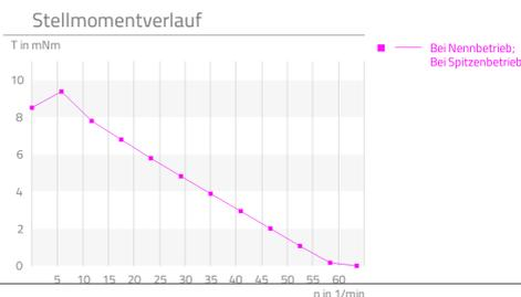
P-029 Kurve gemessen bei 2.5x Nennspannung mit einem Lastträgheitsmoment  $3 \cdot 10^{-9} \text{ kg/m}^2$  im  $\frac{1}{4}$  Mikroschrittbetrieb
