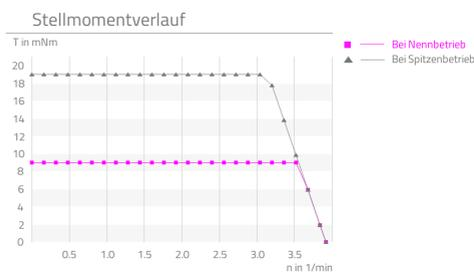
P-029 Kurve gemessen bei Nennspannung mit einem Lastträgheitsmoment  $6 \cdot 10^{-9} \text{ kg/m}^2$  im  $\frac{1}{2}$  Mikroschrittbetrieb
