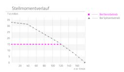
P-029 Kurve gemessen bei 5x Nennspannung mit einen Lastträgheitsmoment 6\*10E-9 kg/m² im  $\frac{1}{4}$  Mikroschrittbetrieb
